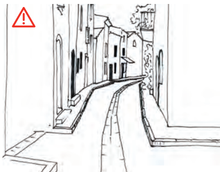
Principe à éviter : Cloisonnement de la rue, soit par nivellement avec des trottoirs soit par des bornes. Ce principe est encore plus à respecter dans les rues étroites.
