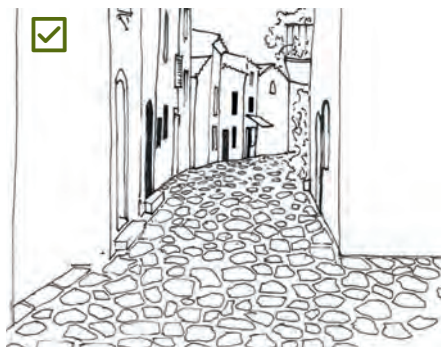
Principe à privilégier : Un traitement de sol homogène de façade à façade avec un matériau unique.
